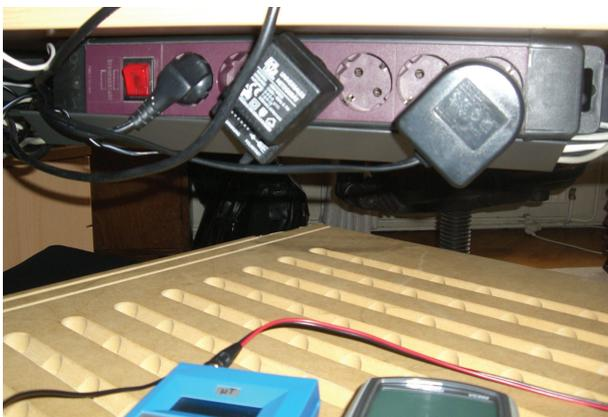
**Abb. 7** Arbeitsplatz mit Netzteilen als Belastungsquellen; im Vordergrund Messraster mit Messgerät und Datenlogger. Aus Gründen der besseren Zugänglichkeit wurde bei der Messung die Steckdosenleiste mit den Netzteilen diagonal unter der Messebene angebracht.
